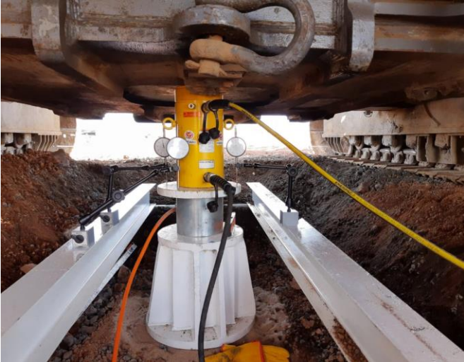
Figura 1. Gato hidráulico, celda de carga y placas de apoyo para aplicar cargas estáticas de compresión a una Columna de Módulo Controlado (CMC)
