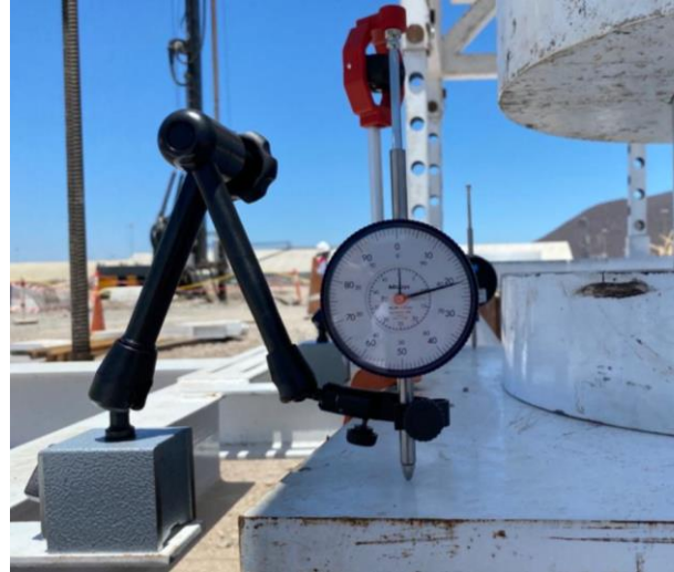
Figura 2. Comparador de carátula (micrómetro) típico utilizado para medir deformaciones totales y velocidades de deformación en la cabeza de una inclusión
