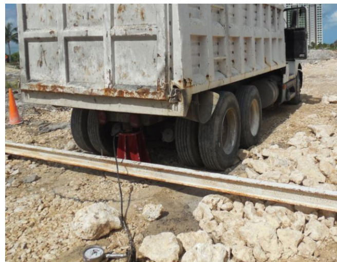
Figura 4. Pruebas de carga estática a compresión (pruebas de placa) realizadas en Columnas de Sustitución Dinámica (CSD) para recepción de los trabajos
